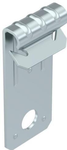
Clip de suspensão com perfuração para soluções de montagem personalizadas, por exemplo, para segurar ganchos em S ou correntes. Fixação a vigas de aço por martelagem.
