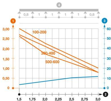
Diagrama de cargas do caminho de cabos do tipo SKSM 60
