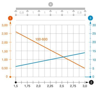
Diagrama de cargas do caminho de cabos do tipo SKSU 60
