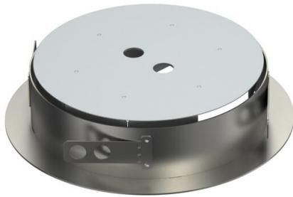
Cofragem de retificação para aplicação direta e simples de tampas niveláveis redondas de tamanho R4 em superfícies de pavimento em betonilha e tijoleira. O revestimento é colocado em caixas de pavimento, com aro de redução de tamanho R4, cobrindo os espaços livres entre a caixa de pavimento e as estruturas da tampa.
