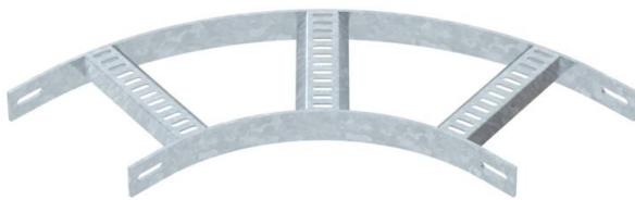
Ângulo de 90° para caminho de cabos construção naval do tipo SL 62 com altura lateral de 40 mm, com degraus trapezoidais soldados, abertos e perfurados para baixo.
