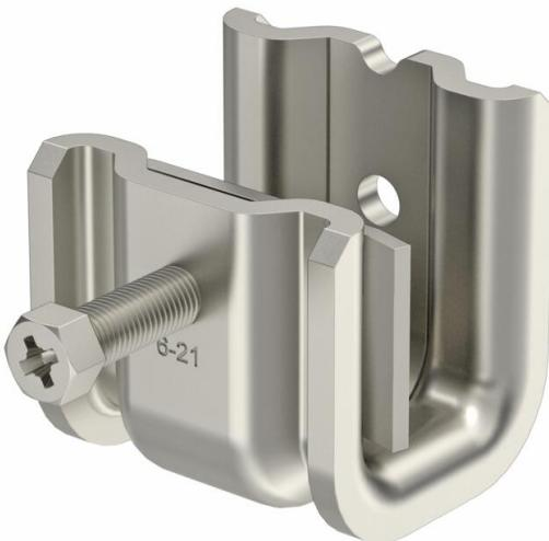
Este tipo de clip de suspensão é encaixado no apoio e fixo à viga ou ferro plano usando uma placa de pressão e um parafuso (M8). O parafuso hexagonal tem um WAF de 10 mm. No clip estão também incorporadas duas roscas M8 adicionais para, por exemplo, fixar um varão roscado.
