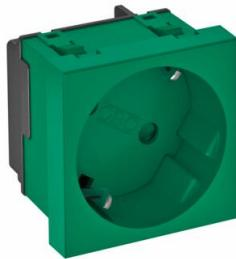
Tomada de contacto de segurança Simples 33°, com alta proteção contra contacto, com ligadores rápidos, 2 polos, 16 A, 250 V~, com bornes de ligação em conformidade com a IEC 60884-1.
