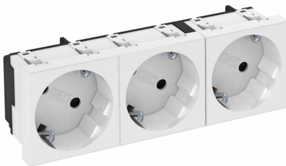
Tomada de contacto de segurança Tripla 33°, com elevada proteção contra contacto acidental, com ligadores rápidos, 2 polos, 16 A, 250 V~, com bornes de ligação em conformidade com a IEC 60884-1.
