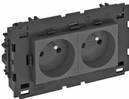
Tomada com pino de terra e ligação lateral, 2 x 0°, com proteção elevada contra contacto acidental, com ligadores rápidos, 2 polos, 16 A, 250 V~, com bornes de ligação conforme IEC 60884-1, indicada para a montagem em sistemas de calhas técnicas Rapid 80.
