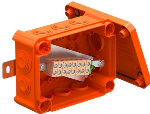
Caixas de derivação para dados com buçins cónicos. Número par de bornes cerâmicos resistentes a elevadas temperaturas, adequados a cabos de dados. Condutor de proteção / borne blindado identificado a verde-amarelo. Fixação a chapas exteriores facilmente acessíveis. Aprovado para instalações de cabos com manutenção de funções elétricas de acordo com a DIN 4102 parte 12 com as classes E30, E60 e E90. Os bornes cerâmicos foram testados segundo a DIN EN 60998-2-1:2004.
