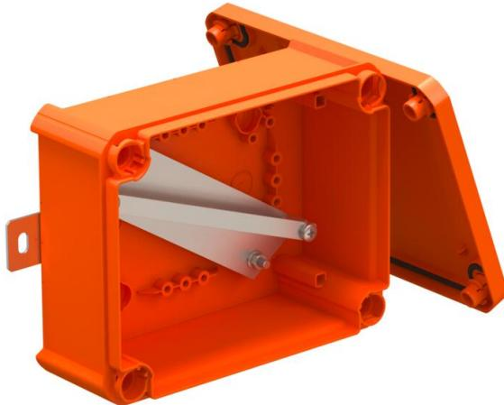
Caixa de ligação ou de derivação de cabos não equipada, fechada para montagem livre com bornes cerâmicos e buçins. A medida A indica o comprimento disponível da calha de suporte para os terminais da cablagem. Espaço da cablagem suficiente devido à calha suporte estar disposta na diagonal. Fixação a chapas exteriores, em aço inoxidável, facilmente acessíveis. Aprovado para instalações de cabos com manutenção de funções elétricas de acordo com a DIN 4102 parte 12 com as classes E30, E60 e E90.
