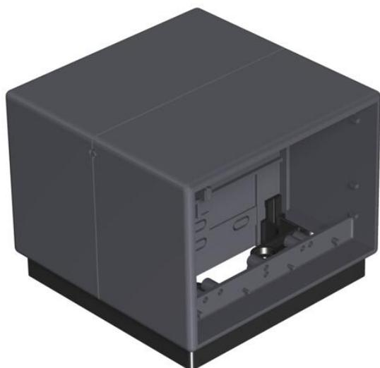
Para a montagem combinada de 4 aparelhos individuais com pega (4 aparelhos de um tipo de corrente ou 2 aparelhos de cada tipo de corrente). Os diferentes tipos de corrente são isolados uns dos outros através de um separador. Calha de fixação roscada para aparelhos: 60 mm vertical.
