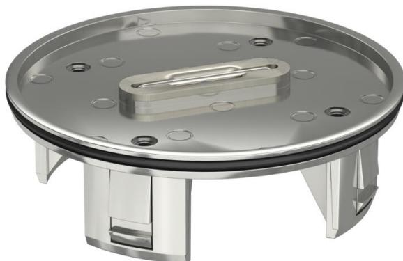
Saída de cabo, variável em altura, para a montagem em cassetes RKF, assim como em tampas niveláveis redondas e quadradas RKFR e RKFN. Saliente no pavimento quando em utilização, ao nível do pavimento quando não utilizado. Aplicação em pavimentos de limpeza com água. Com entalhe de pavimento com 4 mm, para revestimento por parte do cliente utilizando material resistente ao corte, e com arco do punho.
