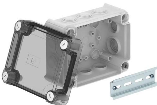
Caixa de derivação para conectar cabos em áreas interiores e áreas exteriores protegidas. Forma retangular com bucins cónicos nas laterais e entradas quebráveis na base. Adequado para a montagem na parede / teto e para a montagem em suportes para caixas de derivação. Com opção de fixação interna e montagem através de parafusos nos cantos. Tampa alta, transparente, com fecho rápido, pode ser selada a chumbo. Fabricada em materiais resistentes aos raios UV e livres de halogéneo.
