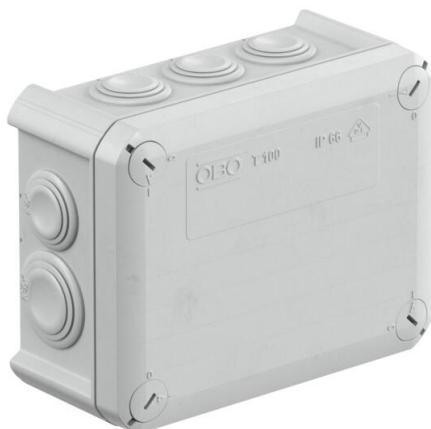
Caixa de derivação para conectar cabos em áreas interiores e áreas exteriores protegidas. Forma retangular com bucins cónicos nas laterais e entradas quebráveis na base. Adequado para a montagem na parede / teto e para a montagem em suportes para caixas de derivação. Com opção de fixação interna e montagem através de parafusos nos cantos. Tampa com fecho rápido, pode ser selada a chumbo. Fabricada em materiais resistentes aos raios UV e livres de halogéneo.
