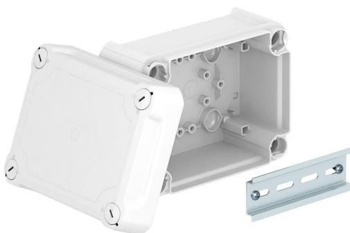
Caixa de derivação fechada para conectar cabos e condutas na área interior e áreas exteriores protegidas. Forma retangular sem entradas. Adequado para a montagem na parede / teto e para a montagem em suportes para caixas de derivação. Com opção de fixação interna e montagem através de parafusos nos cantos. Tampa alta com fecho rápido, pode ser selada a chumbo. Fabricada em materiais resistentes aos raios UV e livres de halogéneo.
