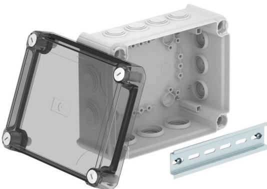
Caixa de derivação para conectar cabos em áreas interiores e áreas exteriores protegidas. Forma retangular com bucins cónicos nas laterais e entradas quebráveis na base. Adequado para a montagem na parede / teto e para a montagem em suportes para caixas de derivação. Com opção de fixação interna e montagem através de parafusos nos cantos. Tampa alta, transparente, com fecho rápido, pode ser selada a chumbo. Fabricada em materiais resistentes aos raios UV e livres de halogéneo.
