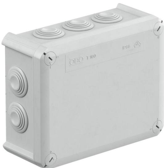
Caixa de derivação para conectar cabos em áreas interiores e áreas exteriores protegidas. Forma retangular com buçins cónicos nas laterais e entradas quebráveis na base. Adequado para a montagem na parede / teto e para a montagem em suportes para caixas de derivação. Com opção de fixação interna e montagem através de parafusos nos cantos. Tampa com fecho rápido, pode ser selada a chumbo. Fabricada em materiais resistentes aos raios UV e livres de halogéneo.
