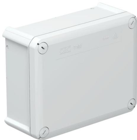
Caixa de derivação para conectar cabos em áreas interiores e áreas exteriores protegidas. Forma retangular sem entradas. Adequado para montagem na parede e teto e a montagem em suportes para caixas de derivação com opção para fixação externa e montagem através de parafusos nos cantos. Tampa com fecho rápido, pode ser selada a chumbo. Fabricada em materiais resistentes aos raios UV e livres de halogéneo.
