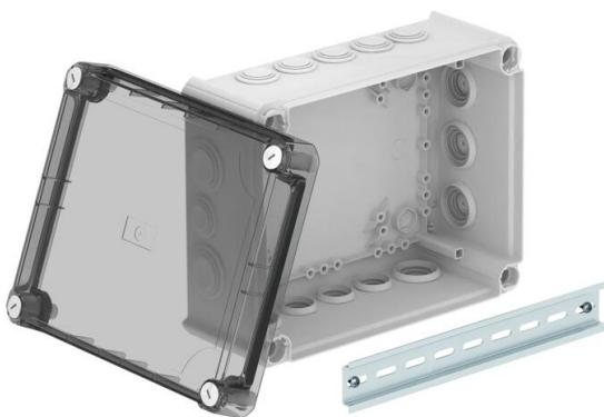
Caixa de derivação para conectar cabos em áreas interiores e áreas exteriores protegidas. Forma retangular com bucins cónicos nas laterais e entradas quebráveis na base. Adequado para a montagem na parede e teto, a montagem em suportes para caixas de derivação e na base da caixa. Com opção de fixação interna e montagem através de parafusos nos cantos. Tampa alta, transparente, com fecho rápido, pode ser selada a chumbo. Fabricada em materiais resistentes aos raios UV e livres de halogéneo.
