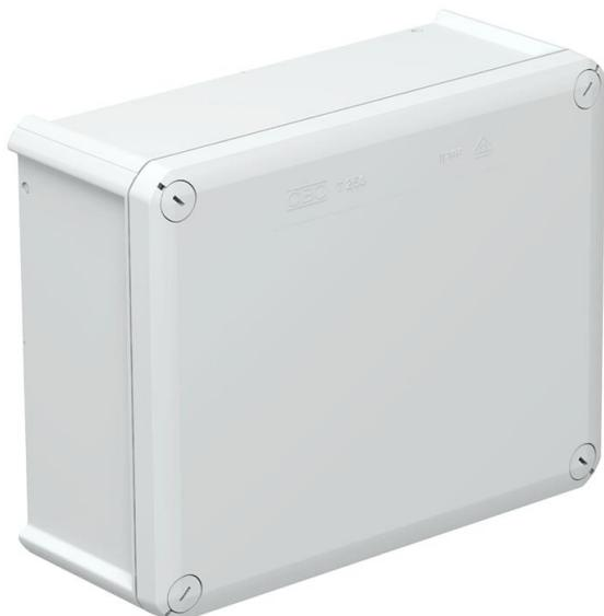
Caixa de derivação para conectar cabos em áreas interiores e áreas exteriores protegidas. Forma retangular sem entradas. Adequado para a montagem na parede e teto, a montagem em suportes para caixas de derivação e na base da caixa. Com opção de fixação interna e montagem através de parafusos nos cantos. Tampa com fecho rápido, pode ser selada a chumbo. Fabricada em materiais resistentes aos raios UV e livres de halogéneo.
