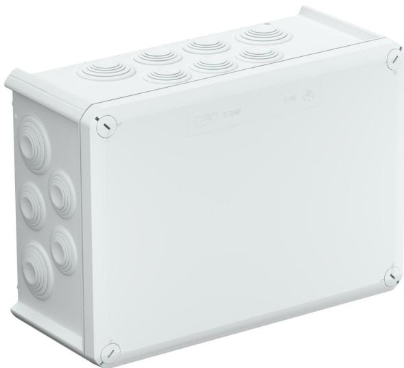
Caixa de derivação para conectar cabos em áreas interiores e áreas exteriores protegidas. Forma retangular com bucins cónicos nas laterais e entradas quebráveis na base. Adequado para a montagem na parede / teto e para a montagem em suportes para caixas de derivação. Com opção de fixação interna e montagem através de parafusos nos cantos. Tampa com fecho rápido, pode ser selada a chumbo. Fabricada em materiais resistentes aos raios UV e livres de halogéneo.
