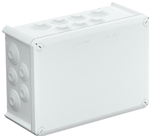
Caixa de derivação para conectar cabos em áreas interiores e áreas exteriores protegidas. Forma retangular com bucins cónicos nas laterais e entradas quebráveis na base. Adequado para montagem na parede e teto e a montagem em suportes para caixas de derivação com opção para fixação externa e montagem através de parafusos nos cantos. Tampa com fecho rápido, pode ser selada a chumbo. Fabricado em materiais livres de halogéneo. Versão resistente ao fio incandescente em polipropileno especial.
