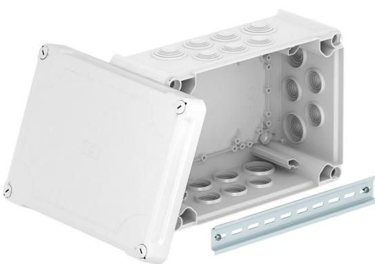
Caixa de derivação para conectar cabos em áreas interiores e áreas exteriores protegidas. Forma retangular com bucins cónicos. Adequado para a montagem na parede e teto, a montagem em suportes para caixas de derivação e na base da caixa. Com opção de fixação interna e montagem através de parafusos nos cantos. Tampa alta com fecho rápido, pode ser selada a chumbo. Fabricada em materiais resistentes aos raios UV e livres de halogéneo.
