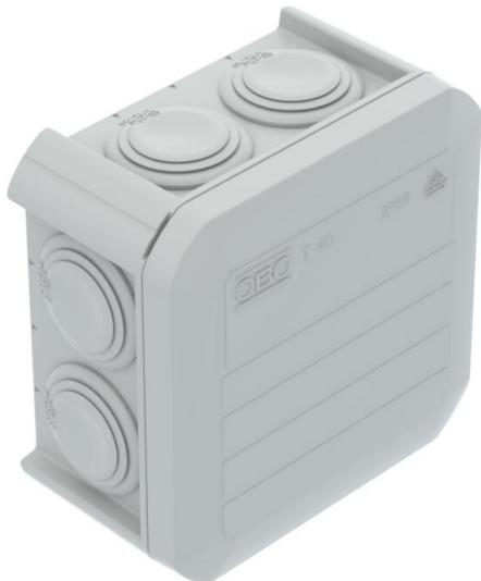
Caixa de derivação para conectar cabos em áreas interiores e áreas exteriores protegidas. Forma quadrada com buçins cónicos nas laterais e entradas quebráveis na base. Adequado para a montagem na parede / teto e para a montagem em suportes para caixas de derivação. Com opção de fixação interna. Com tampa de aperto fixa. Versão resistente ao fio incandescente em polipropileno especial.
