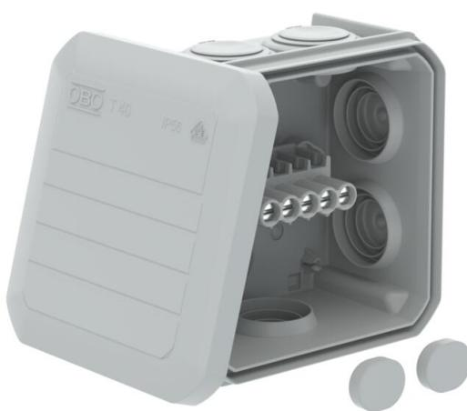
Caixa de derivação com régua de bornes para conectar cabos em áreas interiores e áreas exteriores protegidas. Forma quadrada com bucinos cónicos nas laterais e entradas quebráveis na base. Adequado para a montagem na parede / teto e para a montagem em suportes para caixas de derivação. Com opção de fixação interna. Com tampa de aperto fixa. Fabricada em materiais resistentes aos raios UV e livres de halogéneo.
