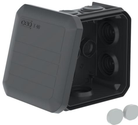
Caixa de derivação para conectar cabos em áreas interiores e áreas exteriores protegidas. Forma quadrada com bucinos cónicos nas laterais e entradas quebráveis na base. Adequado para a montagem na parede / teto e para a montagem em suportes para caixas de derivação. Com opção de fixação interna. Com tampa de aperto fixa. Fabricado em materiais resistentes aos raios UV e livres de halogéneo.
