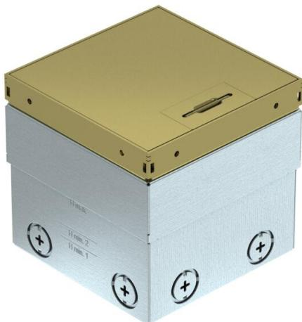
Caixa de pavimento quadrada para utilização em chão falso e betonilha, de limpeza a seco. Caixa com aberturas de entrada para tubos (M20/M25). Tampa ajustável ao reborde superior do revestimento do pavimento, através de 4 apoios de nivelamento. A profundidade mínima de montagem é de 100 mm, a amplitude de nivelamento + 35 mm.
