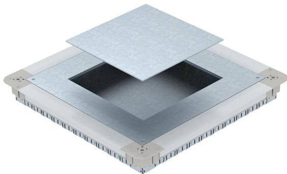
Caixa de pavimento com aro de redução e tampa cega com paredes laterais de chapa de aço. Para a instalação de tampa de encastramento quadrada GES9 55 em alturas de pavimento a partir de 55 mm. Pode ser continuamente nivelada até à altura da betonilha e a betonilha pode ser nivelada com a aresta de descarga da betonilha. Com aberturas para tubos de condução de cada lado 7 x M20, 3 x M25, 4 x M32. Tamanho útil do tubo com altura de sistema de 55 mm: M20.
