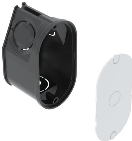
Caixa de aplicação de encastrar para colocação de cabo monofásico. Formato oval, para utilização em alvenaria com uma profundidade de instalação de pelo menos 35 mm.
