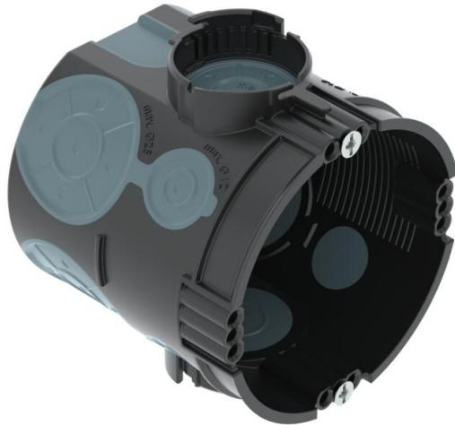
Caixa de aparelhagem de encastrar com entradas de membrana herméticas, para utilização em alvenaria com uma profundidade de instalação de pelo menos 66 mm.
