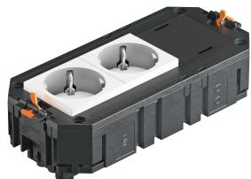
O suporte universal UTC3 pronto para ligação possui duas tomadas de contacto de segurança 33° pré-instaladas e um espelho cego para a montagem posterior de um aparelho de instalação da série Modul 45 ou Modul 45connect. Adequado aos cabos de ligação VL e às unidades de montagem de aparelhos do tamanho nominal 2, 4, R4, 6 e R7.
