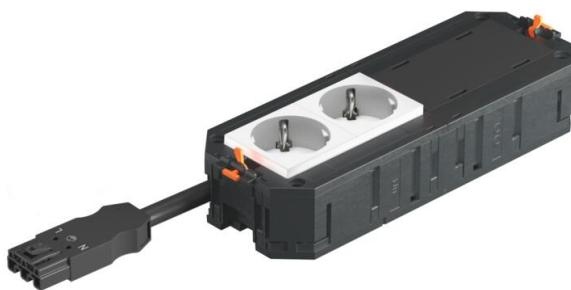
O suporte universal UTC4 pronto para ligação possui 2 tomadas de contacto de segurança 33° pré-instaladas em branco e 2 obturadores para a montagem posterior de 2 aparelhos de instalação da série Modul45. Adequado aos cabos de ligação VL e às tampas de tamanho R7, R9 e 9.
