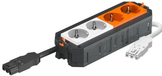
O suporte universal UTC4 pronto para ligação possui 2 tomadas de contacto de segurança 33° pré-instaladas em branco e 2 tomadas de contacto de segurança 33° pré-instaladas em laranja, 250 V~ 16 A. Adequado aos cabos de ligação VL e às tampas de tamanho R7, R9 e 9.
