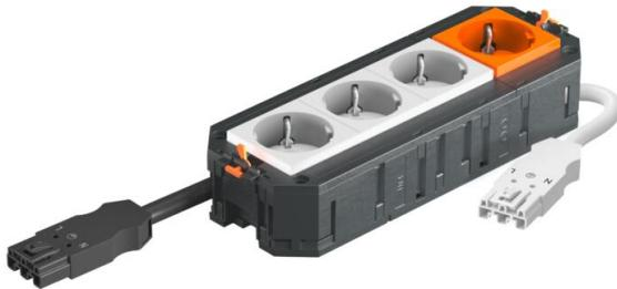
O suporte universal UTC4 pronto para ligação possui 3 tomadas de contacto de segurança 33° pré-instaladas em branco e uma tomada de contacto de segurança 33° pré-instalada em laranja, 250 V~ 16 A. Com cabo de ligação livre de halogéneos. Adequado aos cabos de ligação VL e às tampas de tamanho R7, R9 e 9.
