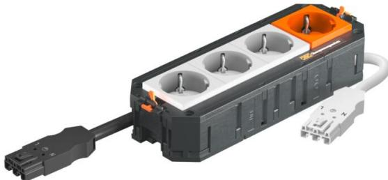
O suporte universal UTC4 pronto para ligação possui 3 tomadas de contacto de segurança 33° pré-instaladas em branco e uma tomada de contacto de segurança 33° pré-instalada em laranja (com módulo de proteção contra sobretensões tipo 3 conforme a DIN EN 61643-11), 250 V~ 16 A. Adequado aos cabos de ligação VL e às tampas de tamanho R7, R9 e 9.
