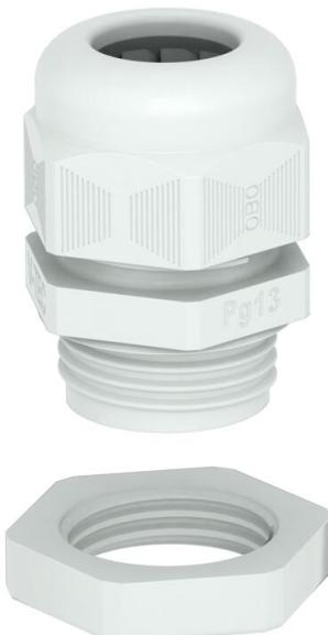
Bucim com rosca de ligação PG em design de porca de capa, para caixas de derivação, caixas, caixas de distribuição no sector privado e industrial. Com alívio de tensão e rebordo de vedação integrado testados de acordo com a DIN EN 62444. Classe de proteção IP68. Aplicável de -20 °C a +65 °C. Inclui contraporca.
