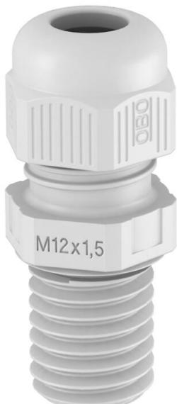
Bucim com rosca de ligação métrica em design de porca de capa, para caixas de derivação, caixas, armários de distribuição no sector privado e industrial. Com alívio de tensão e rebordo de vedação integrado testados de acordo com a DIN EN 62444. Classe de proteção IP68. Aplicável de -20 °C a +65 °C.
