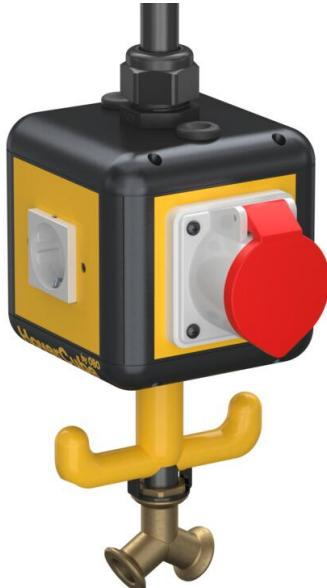
Caixa equipada e pré-cablada com tubo de 1 m e 1/2", ligação para tubo flexível de ar comprimido de 13 x 3,5 mm e distribuidor de 2 vias de 1/2", com olhal de suspensão, gancho e 4 espelhos.
