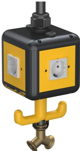
Caixa equipada e pré-cablada com tubo de 1 m e 1/2", ligação para tubo flexível de ar comprimido de 13 x 3,5 mm e distribuidor de 2 vias de 1/2", com olhal de suspensão, gancho e 4 espelhos.
