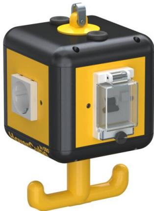
O Hovercube VH-4 com proteção descentralizada aciona diretamente o interruptor FI/LS no caso de uma sobretensão ou falha de corrente (16 A/30 mA). Pode ser novamente ligado diretamente na unidade de distribuição de energia.
