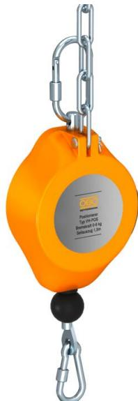
Roldana para o ajuste em altura variável de um ponto de distribuição VH, capacidade de carga de 0,5 até 6,0 Kg, curso de cabo máximo de 1,5 m.
