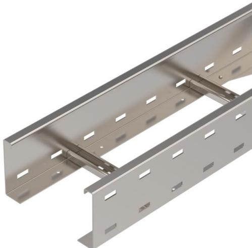
Caminhos de cabos tipo escada, para grandes vãos com perfuração lateral com 110 mm de altura lateral. Fixação de cabos e condutas com abraçadeira BSS tipo 2056.
