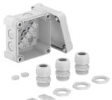
Caixa de derivação com régua de bornes para conectar cabos e tubos em áreas interiores e exteriores. Forma quadrada com entradas quebráveis. Adequado para montagem na parede e teto com opção para fixação externa ou montagem através de parafusos nos cantos. Particularmente resistente ao impacto com IK09. Tampa com fecho rápido, pode ser selada a chumbo. Fabricada em materiais resistentes aos raios UV e livres de halogéneo.
