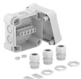
Caixa de derivação com régua de bornes para conectar cabos e tubos em áreas interiores e exteriores. Forma quadrada com entradas quebráveis. Adequado para montagem na parede e teto com opção para fixação externa ou montagem através de parafusos nos cantos. Particularmente resistente ao impacto com IK09. Tampa com fecho rápido, pode ser selada a chumbo. Fabricada em materiais resistentes aos raios UV e livres de halogéneo.
