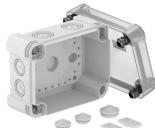
Caixa de derivação para conectar cabos e tubos em áreas interiores e exteriores. Forma retangular com entradas quebráveis. Adequado para montagem na parede e teto com opção para fixação externa ou montagem através de parafusos nos cantos. Particularmente resistente ao impacto com IK09. Tampa transparente com fecho rápido, pode ser selada a chumbo. Fabricada em materiais resistentes aos raios UV e livres de halogéneo.
