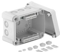
Caixa de derivação com régua de bornes para conectar cabos e tubos em áreas interiores e exteriores. Forma retangular com entradas quebráveis. Adequado para montagem na parede e teto com opção para fixação externa ou montagem através de parafusos nos cantos. Particularmente resistente ao impacto com IK09. Tampa com fecho rápido, pode ser selada a chumbo. Fabricada em materiais resistentes aos raios UV e livres de halogéneo.
