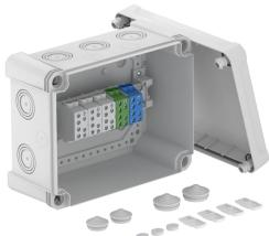
Caixa de derivação para conectar cabos e tubos em áreas interiores e exteriores. Forma retangular com entradas quebráveis. Adequado para montagem na parede e teto com opção para fixação externa ou montagem através de parafusos nos cantos. Particularmente resistente ao impacto com IK09. Tampa com fecho rápido, pode ser selada a chumbo. Fabricada em materiais resistentes aos raios UV e livres de halogéneo.
