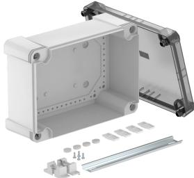
Caixa de derivação com calha DIN para conectar cabos e tubos em áreas interiores e exteriores. Forma retangular sem entradas. Adequado para montagem na parede e teto com opção para fixação externa ou montagem através de parafusos nos cantos. Particularmente resistente ao impacto com IK08. Tampa transparente com fecho rápido, pode ser selada a chumbo. Fabricada em materiais resistentes aos raios UV e livres de halogéneo.
