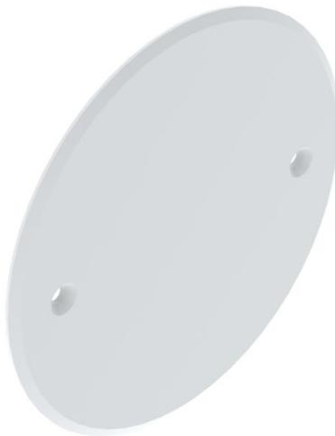
Tampa universal para caixa de encastrar e para paredes ocas. Com aberturas, espaçamento entre furos de 60 mm para caixa de aparelhagem e caixa de derivação, parafusos embutíveis. Superfície rugosa.
